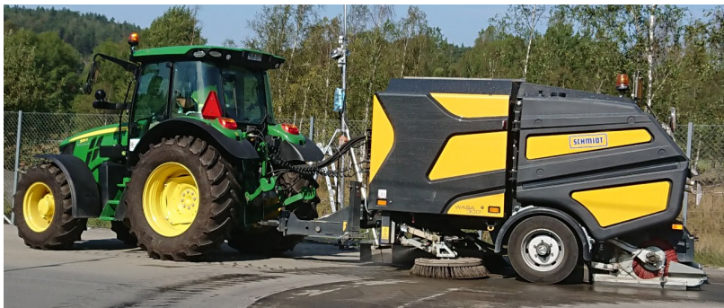
Figur B4 Den traktordragna stadmaskinen som användes för testerna.
