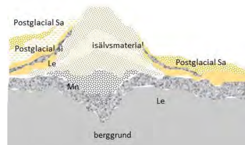
Figur 4. Schematisk tvärsnitt av Årsunda- eller Enköpingsåsen vid Rökebo (Sa: sand; Si: silt; Le: lera; Mn: morän)
