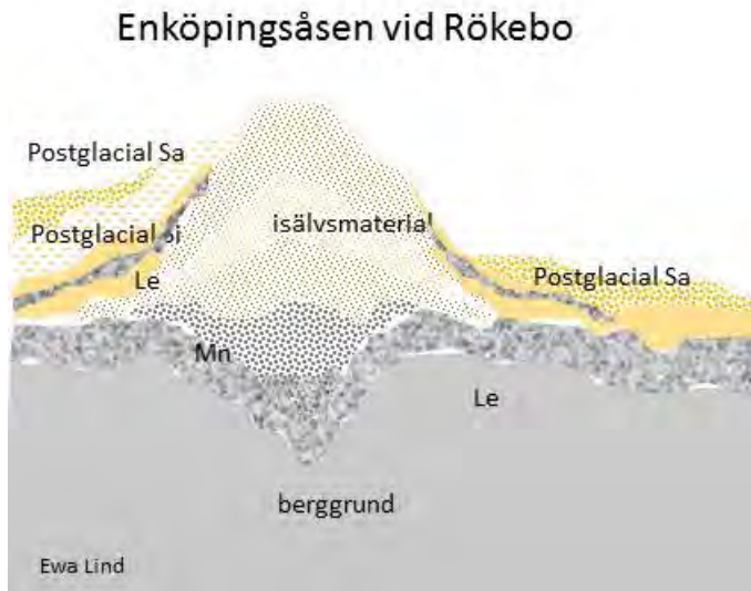
Figur 4-2. Schematisk tvärsnitt av Årsunda- eller Enköpingsåsen vid Rökebo (Sa: sand; Si: silt; Le: lera; Mn: morän)
