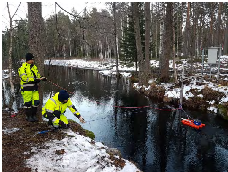
Figur A. 3 Kontrollmätning av vattenföring med ADCP i december 2019. Sensorinstallationen med loggerskåpet syns till höger i bild.
