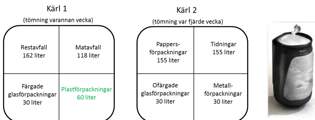
Figur 2. Fackindelning i fyrfackskärlet inom Jönköpings kommun samt en "minimizer" för att komprimera mjuka plastförpackningar. (Bild: PWS AB)
